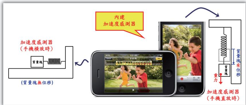
圖四 微型加速度計的應用範例—手機螢幕自動旋轉
