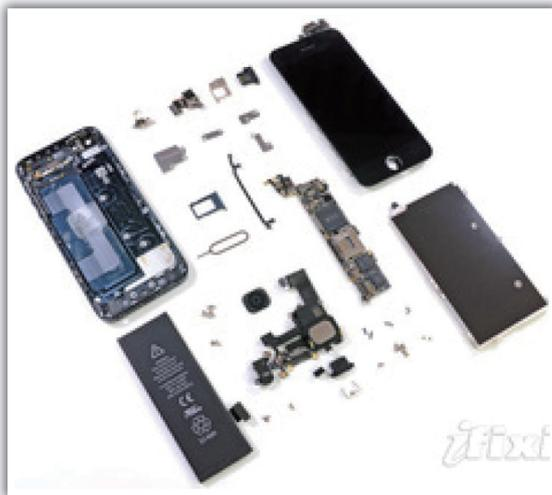
圖一 iPhone 5 手機拆解圖 (www.ifixit.com)
