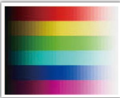
至於如何顯示器可以呈現出多少種的顏色呢？事實上是決定在驅動 IC 的能力上。以 8-bit 驅動 IC 為例，可以讓液晶呈現  $2^8$  種灰階，因此紅綠藍各可以呈現 256 種不同深淺的灰階，三種顏色組合後可以得到 16.7 百萬色的顯示能力。
