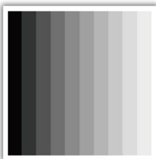
液晶顯示器為什麼可以呈現不同的灰階？剛剛提到的，在電壓驅動下，可以讓液晶層形成不同的相位延遲值，使得光源透過偏光片，經過液晶層，再經過偏光片後，可以得到不同的亮度。至於到底能有幾種亮度差異，決定在顯示器的驅動 IC 能力上。以 8bit IC 為例，可以將黑到白分成  $2^8$  種，也就是由黑到白有 256 種不同的亮度，如此就能呈現黑白的畫面，當 bit 數愈多時，就能呈現愈多的灰階，顯示畫面也就愈連續，如此，畫面看來就愈接近真實的感覺。
