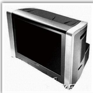
19 世紀末，科學家發現，當陰極射線在真空腔體中撞擊螢光粉時會發出可見光。研究人員經過多年的研發後，開發出陰極射線管顯示器（Cathode ray tube，簡稱 CRT），利用電子槍發射電子束，以磁場控制電子偏折角度打在鍍有磷光材質的映像管的紅綠藍畫素上。每個磷光點是一個影像顯示畫素，經由掃描像素點，即可顯示畫面。但是映像管龐大的體積與沈重的重量，是先天的缺點，使得這類顯示器無法隨身攜帶。
